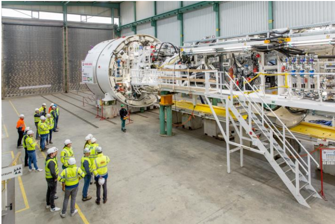
Werksabnahme der neuen Tunnelvortriebsmaschine © Herrenknecht AG
